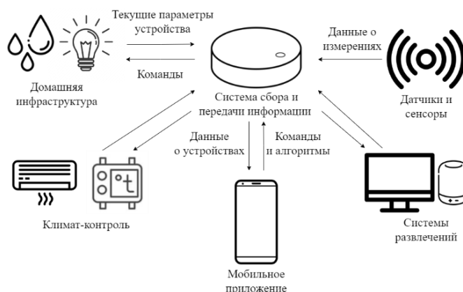
Рисунок 1 – Схема работы системы сбора и передачи информации с мобильным приложением и с подключаемыми устройствами
