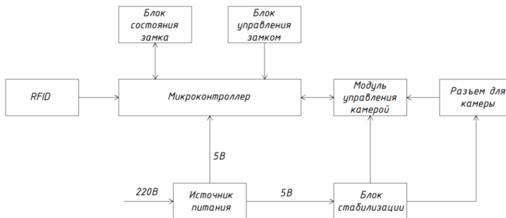
Рисунок 1 – Схема электрическая структурная устройства «Замок с интеллектуальным управлением с мобильным приложением»
