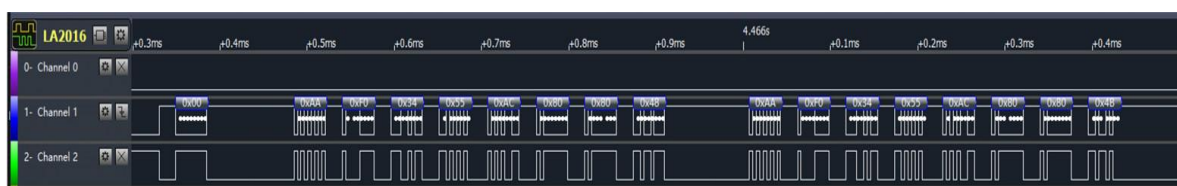
Рисунок 2 – Передача данных от контроллера к LED-панели
