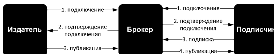
Рисунок 1 – Схема обмена информацией между клиентом и сервером
