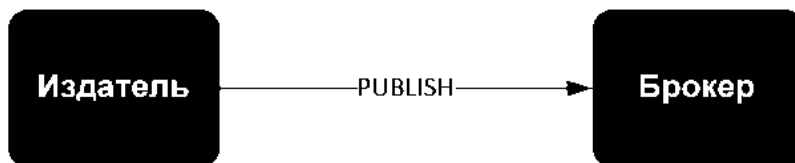
Рисунок 5 – QoS 0 At most once.
