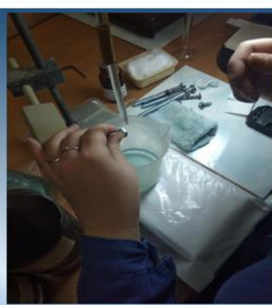
Контроль толщины покрытия по ГОСТ 9.302-88 – оператор-гальваник
